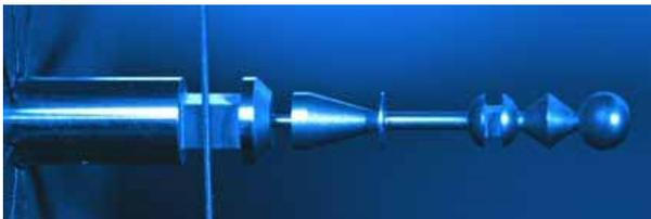
Mit unserer 8-Achs-Simultan-Steuerung lassen sich zum Beispiel verdrehte Werkstücke mit unterschiedlichen Steigungen herstellen.
